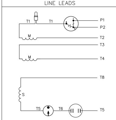
ROTATION INSULATE FACING L2 JOIN L1 SEPARATELY LEAD END T4 T5 T2,T3 T8 C.C.W. P1 P2 HIGH T4 VOLT T2,T3 Р2 C.W. T8 T5 T2,T4 P2,T3 C.C.W. P1 LOW T5 T8 **VOLT** T2,T4 P2,T3 C.W. P1 T8 T5
