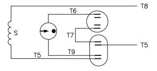
ROTATION L2 FACING L1 JOIN (BLANK) LEAD END C.C.W. T4,T5 T1,T8,P3 Р1 C.W. P1 T4,T8 T1,T5,P3
