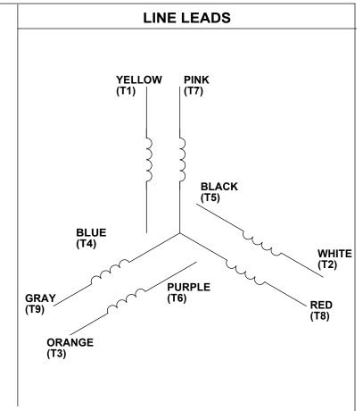
**JOIN & VOLTAGE** L1 L2 L3 INSULATE (T4, T7)HIGH T1 T2 T3 (T5,T8)(T6,T9) LOW T1,T7 T2.T8 T3,T9 T4,T5,T6
